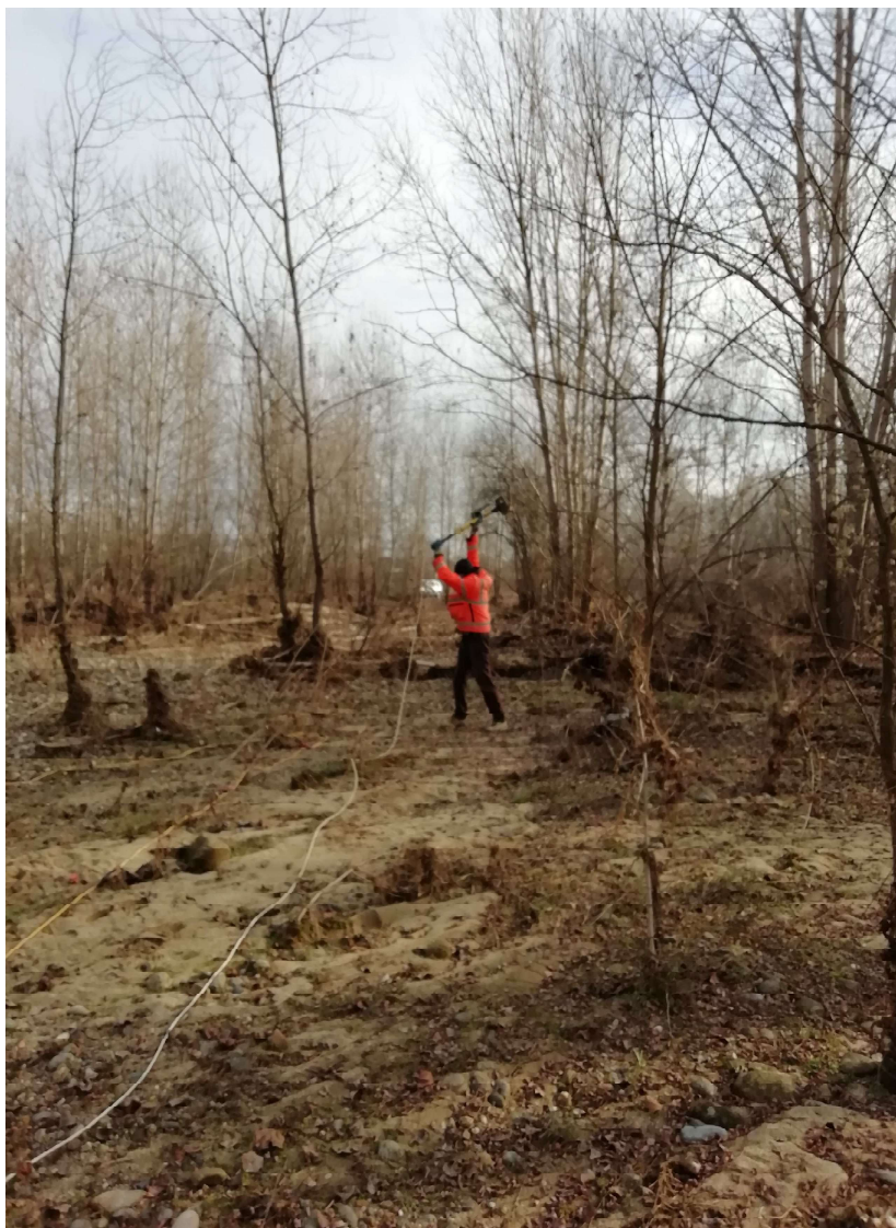
Figura 5.1: Energizzazione durante lo stendimento per la MASW eseguita a Rivarolo C.se
